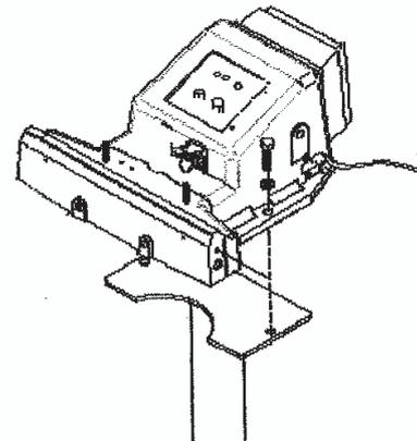
Рисунок 4.2 – Установка сваривающей головки
